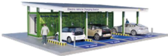
Para sitios aislados donde no haya energía para la carga eléctrica de los automoviles, se instalan paneles solares y baterías de litio fosfato, con un inversor y salida para diferentes cargadores de coches eléctricos.
