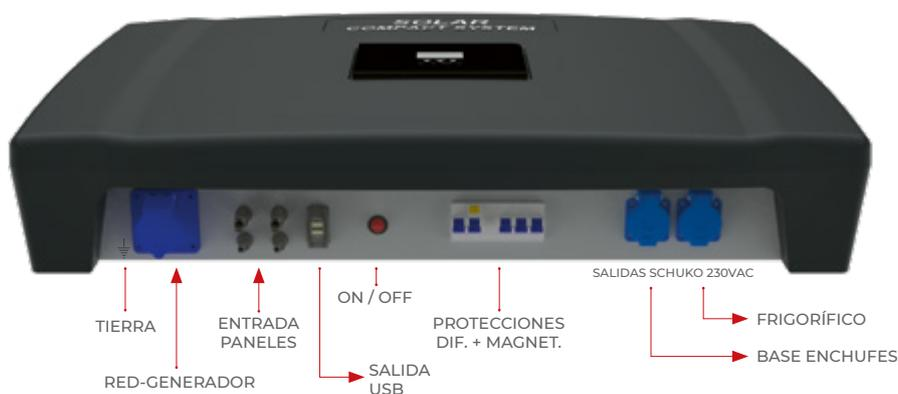
El kit **CSV51C** es un sistema compacto de 1 inversor cargador marca VICTRON ENERGY (ver características en tabla adjunta) más 1 controlador **SMART SOLAR** con **MPPT** y 1 ó 2 baterías de **51,2V** de **LiFePO<sub>4</sub>** con descarga del 100% todo conectado dentro de un armario de chapa galvanizada (modelo CSV51-08) y pintado con pintura epoxi y los demás modelos con tapa en **ABS** y colores a elegir.
