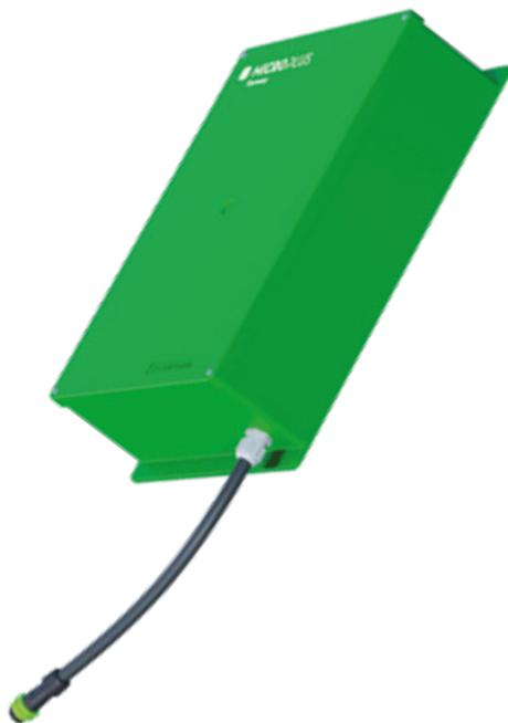
Nuestras farolas almacenan la energía en baterías de litio fosfato ([pag. 166](#)) con pilas 32.700 de 8.000 ciclos que se suministra con caja ABS conectores IP68 y un BMS para la carga equilibrada de la misma .
